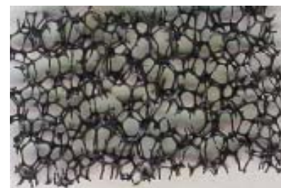
Рис. 5 Пористая пена средней жесткости, с различным размером пор ppi 10
