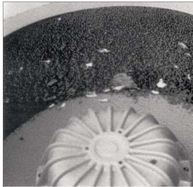
Рис. 10 Теплообменное кольцо после 2-х лет эксплуатации в частном бассейне.
