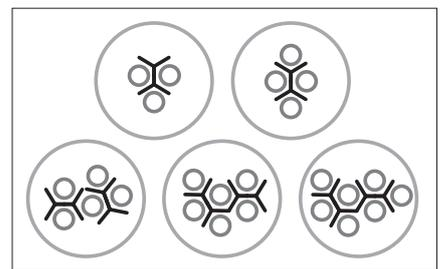
Для герметизации 3-х и более кабелей необходимо прокладывать между ними специальную герметизирующую вставку RDSS-Clip.
