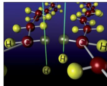
Если материал прошел процесс поперечной сшивки, он уже не будет плавиться или течь при повышении температуры. При нагреве кристаллическая структура пропадает, как и прежде, но материал не потечет и не изменит формы, потому что поперечные связи действуют как стяжки между молекулами. В то же время поперечно-сшитая структура обладает эластичностью. Когда материал нагревается до температуры, при которой нарушается кристаллическая структура, он становится резиноподобным.
