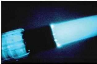
В кабельной арматуре Райхем применяются высококачественные изоляционные материалы и эффективные системы выравнивания НЭП, и как результат, уровень ЧР в муфтах не превышает 1 пКл. Для измерений ЧР требуется чувствительное оборудование, которое выделяет ЧР из шумового фона. ЧР не должны возникать при напряжении  $2xU_0$ . В наших лабораториях мы постоянно проводим испытания на ЧР при разработке и квалификации кабельной арматуры. Испытания проводятся до, во время и после циклических испытаний.
