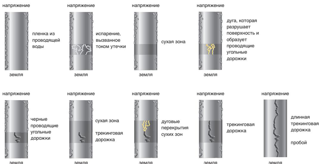
На рисунках показано возникновение трекинговых дорожек. При эрозии процесс разрушения идет вглубь материала.
