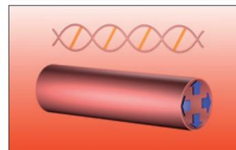
Трубка охлаждается в расширенном деформированном состоянии. Появляется кристалличность, которая закрепляет структуру материала в растянутом виде. Это та форма, в которой трубка поставляется заказчиком. В таком виде трубка может храниться неограниченно долго.
