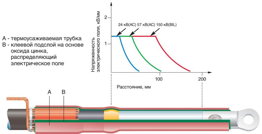
**Полупроводящие трубки распределения электрического поля в соединительных муфтах Райхем**
