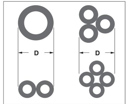
Диаметр кабеля или кабельной связи
