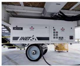
MOBILE DIESEL GROUND POWER UNITS (GPUs)
